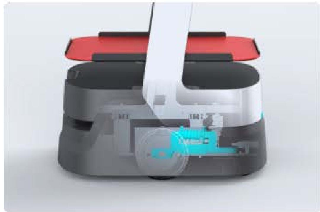
Systeme de suspension de véhicule multibras
